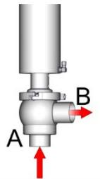
Предпочтительное положение установки предохранительного клапана вертикальное, пневматическим приводом вверх. Для клапанов с установленным давлением срабатывания  $\leq 0,5$  бар вертикальное положение для монтажа является рекомендуемым. Клапан должен быть установлен таким образом, чтобы жидкость не оставалась в его корпусе и свободно вытекала через порт «В».
