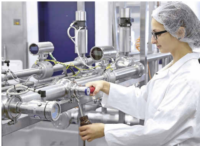
Die aseptischen Probenahmeventile von Kieselmann vereinen hohe Funktionalität mit einer leichtgängigen Bedienbarkeit
